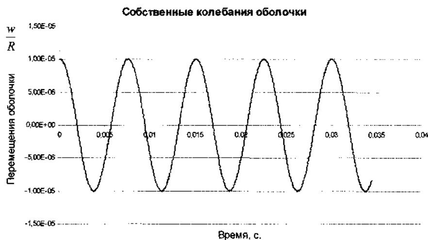
Ниже представлено распространение возмущения оболочки по меридиану при выведении оболочки из состояния равновесия путём задания перемещения по экватору. В полярных точках сфера жёстко закреплялась. Выполнялся контроль по скорости распространения волн.
