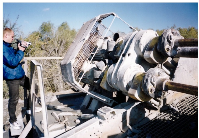
Рис. 3. Вібраційний грохіт з направленими коливаннями (кар'єр компанії «Юнігран», м.Малин)
