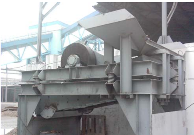
Рис. 2. Вібраційний грохіт з коловими коливаннями (завод ім. Ковальської, м.Київ)
