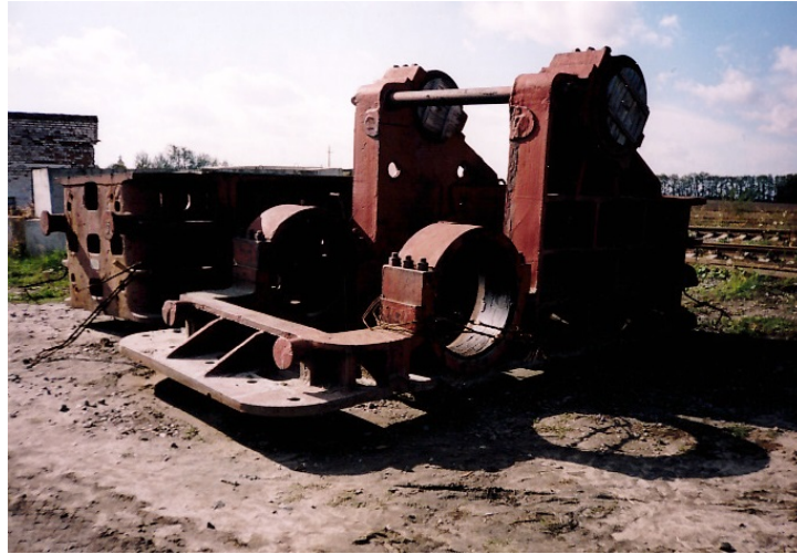
Рис. 1. Станина з корпусами підшипників щоквої дробарки ЩДП 9x12 (кар'єр компанії «Юнігран», м. Малин)
