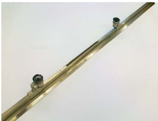
Рис. 1. Загальний вид штрихового метра МШ1Р
