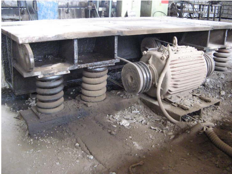
Рис. 4. Вібраційна площадка для формування панелей перекриття (завод «Перемога», м. Ірпінь, Київська обл.)
