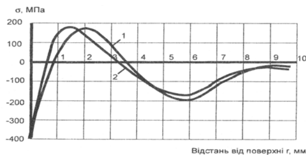
Рис. 1. Епюра розподілу залишкових напружень в ПП, відновлених запропонованим способом: 1 - теоретична крива; 2 - експериментальна крива
