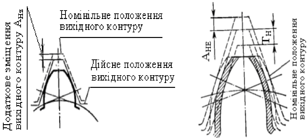
Рис. 1. Зміщення вихідного контуру
