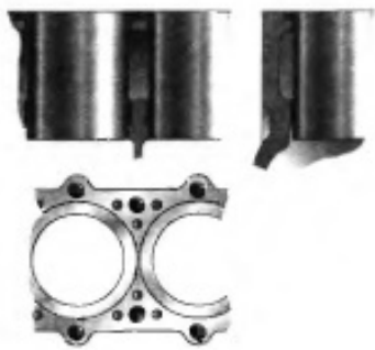
Рис. 20. Чавунний блок з “мокрими” гільзами, які опираються на верхню частину блока.
