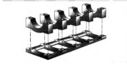
Рис. 5. Додаткова рама для кріплення кришок корінних підшипників.
