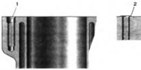
Рис. 13. Отвір болтів кріплення головки блока циліндрів: 1-проточка; 2-деформація при відсутності проточки.
