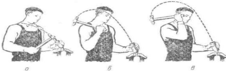
Рис. 67. Удари молотком: а – кистевий; б – ліктьовий; в – плечовий
