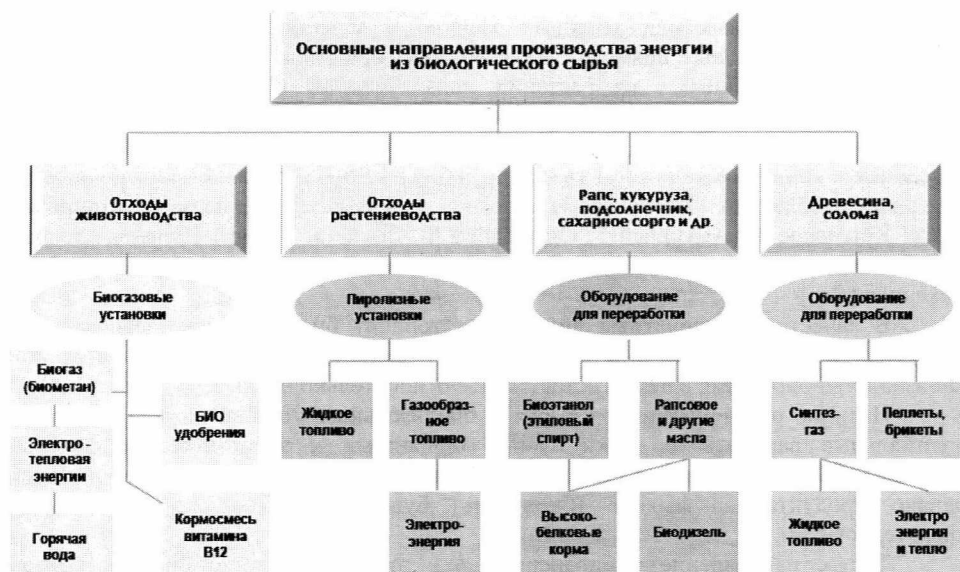
Рис. 2. Основные направления переработки биомассы в энергию и топливо
