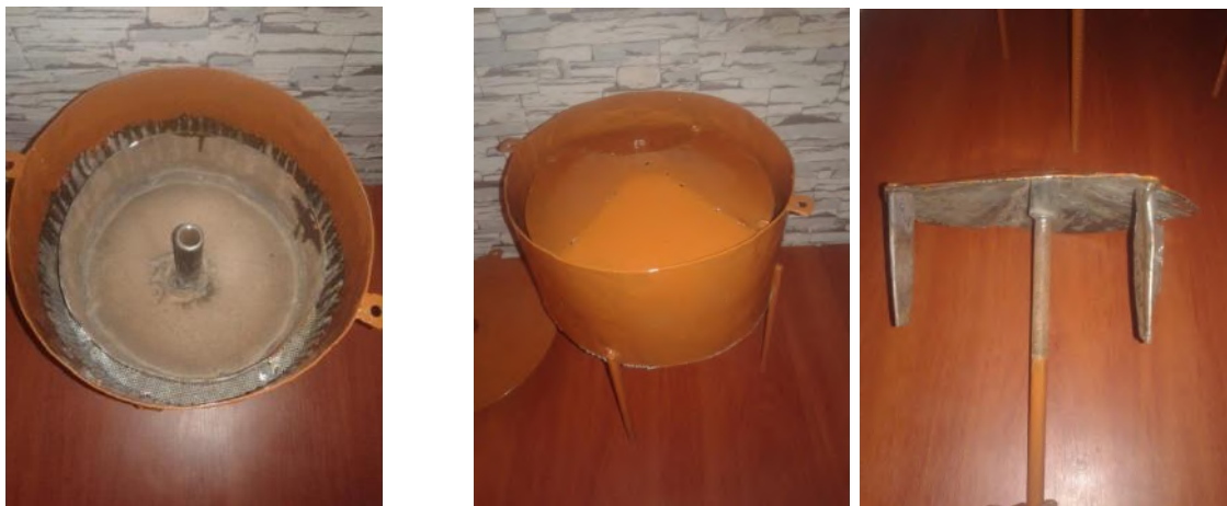
Рисунок 3 – Лабораторна установка для визначення параметрів гранулювання лляного жмиху
