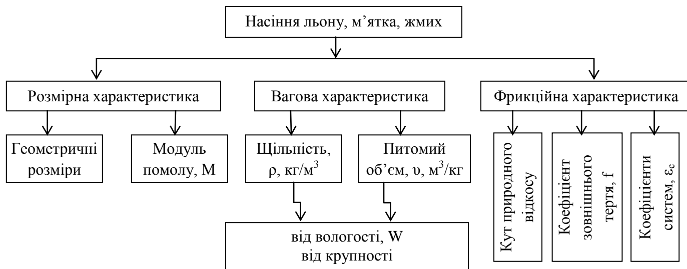
Рисунок 2 – Структурна схема експериментальних досліджень з вивчення фізико-механічних властивостей насіння льону олійного, м'ятки та жмиху
