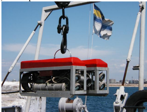
Рис. 2. Спускаемый подводный аппарат рамного исполнения «Агент – 1»
