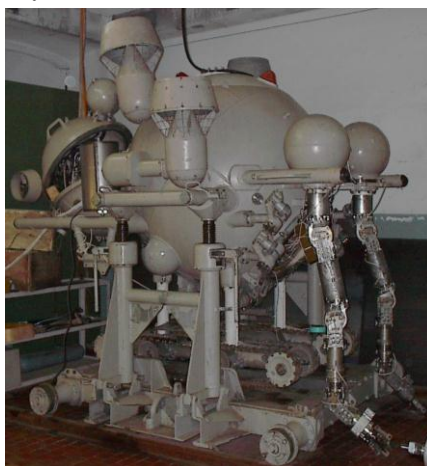
Рис.4. Самоходный (в погружном и доном положениях) спускаемый подводный аппарат "МТК – 200"
