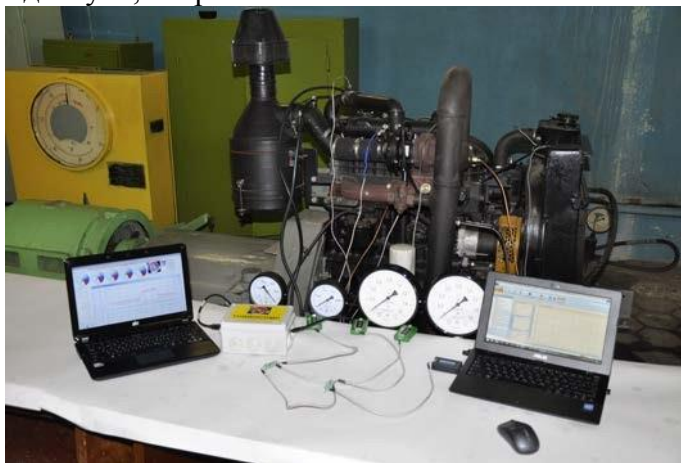
Рис. 1. Вимірювальна система з вивчення показників роботи системи наддуву, встановлена на двигуні Д-245-35 і ТКР-6.1 з використанням обкатного гальмівного стенду КІ 5543 ГОСНИТИ
