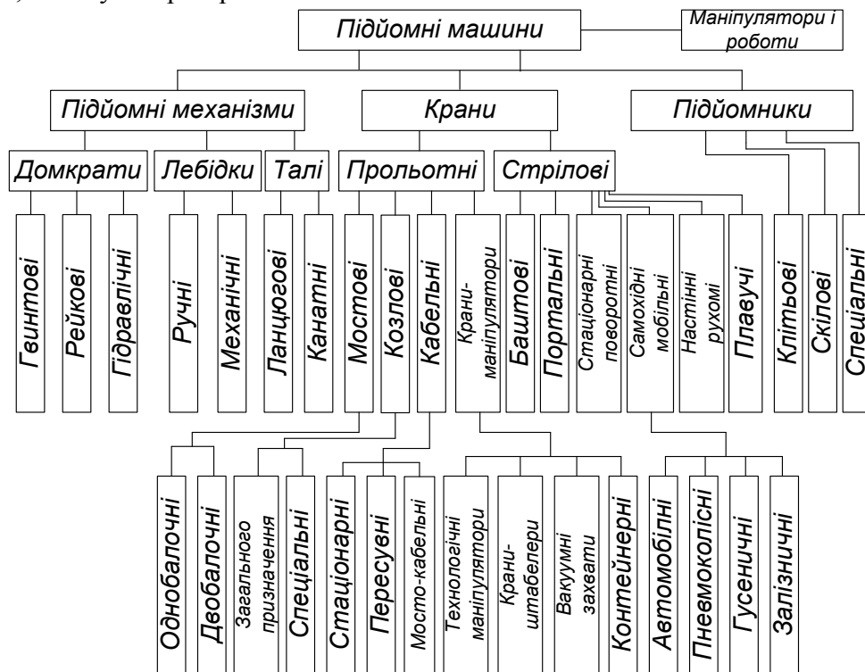
Рис. 1. Класифікація підйомальних машин
