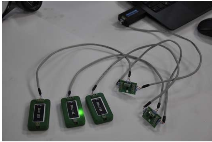
Рис. 2. ZET 7020 TermoTC-CAN інтелектуальний термодатчик термопари с интерфейсом CAN)
