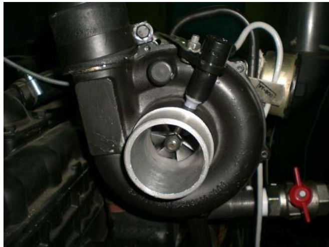
Рис. 3. Пристрій вимірювання частоти обертання валу ТКР
