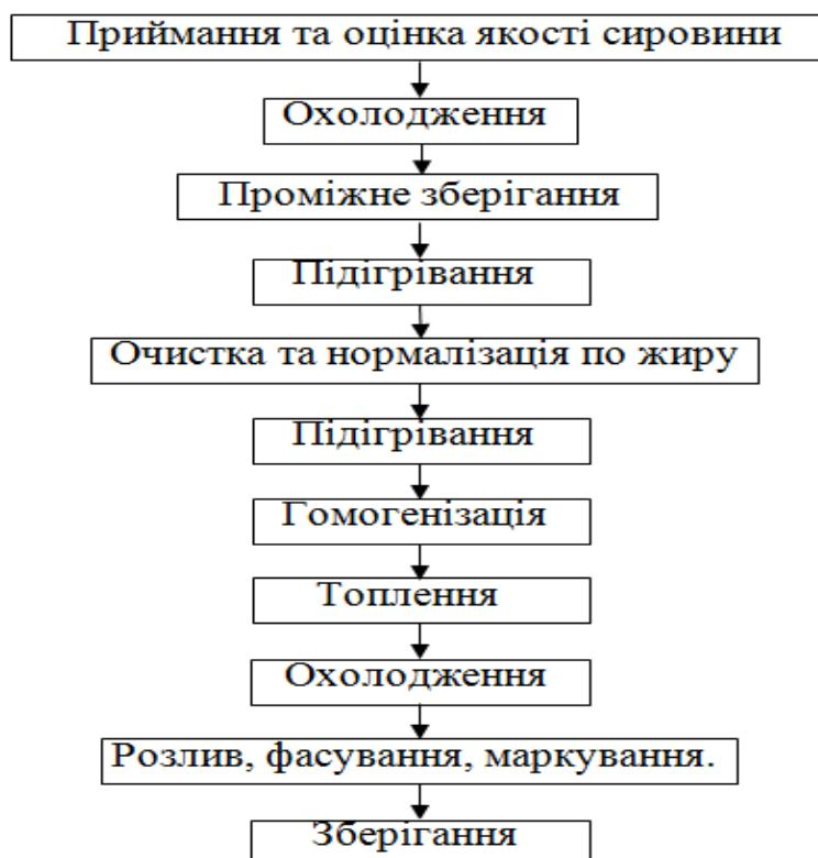
Рис. 4. Технологічна схема виробництва пряженого молока
