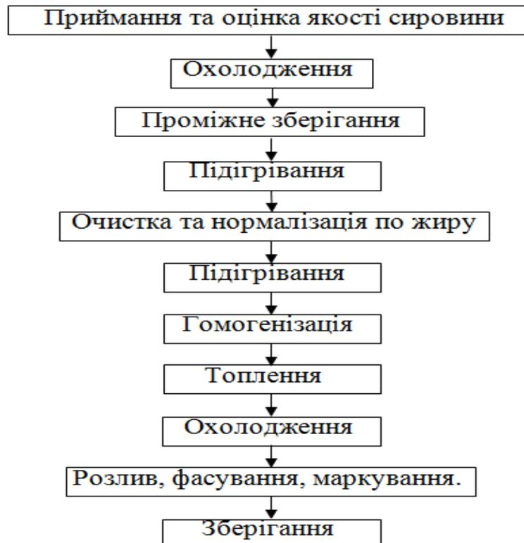
Рис. 4. Технологічна схема виробництва пряженого молока
