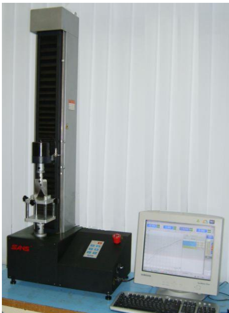
Рис. 1. Універсальна випробувальна машина SANS CMT2000, модель 2503
