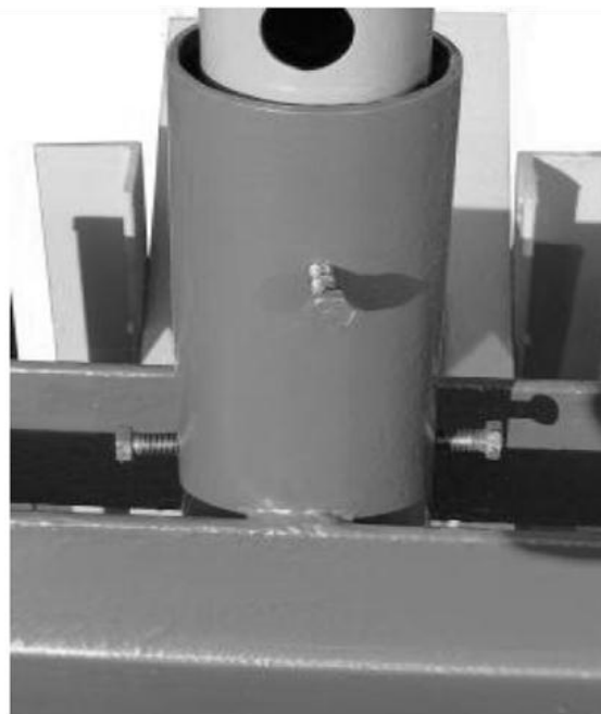
Рис. 5. Регулювання висоти встановлення труби
