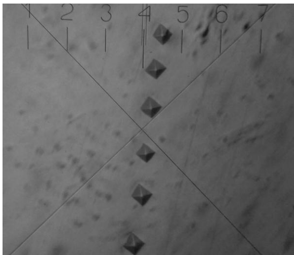
Рис. 4. Измерение отпечатков микротвердости на приборе ПМТ-3 ( \times 500 )
