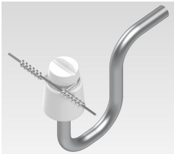
Рис. 2. Просторова модель ізоляторного пристрою ТФ-20 01: a – реалістична модель з урахуванням властивостей матеріалів; б – кінцево-елементна модель
