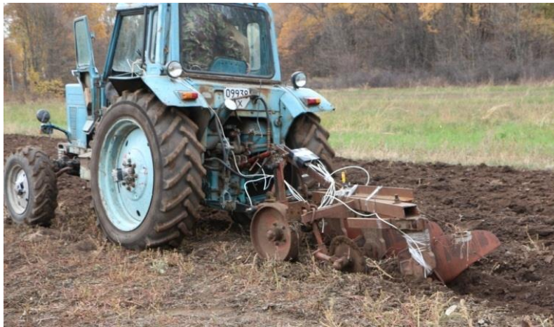
Рис. 6. Загальний вигляд вимірювальної системи з датчиками, встановленими на тракторі МТЗ-82 і начіпному лемішному плугі ПЛН-3-35
