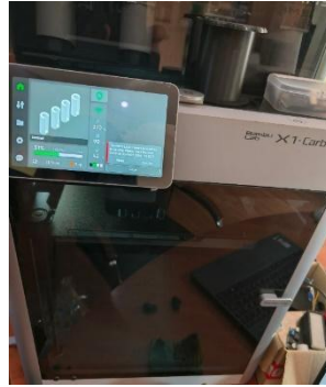
Рисунок 1. Процес друку деталей на Bambu Lab X1 Carbon
