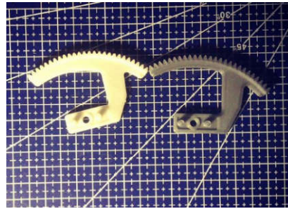
Рис.2. Деталі рухомих з'єднань, виготовлені за допомогою 3D-друку
