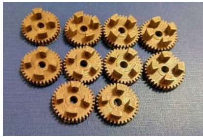
Рис.2. Деталі рухомих з'єднань, виготовлені за допомогою 3D-друку
