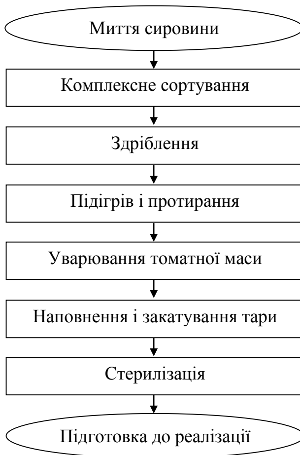
Рис. 1. Блок-схема виробництва томатної пасти
