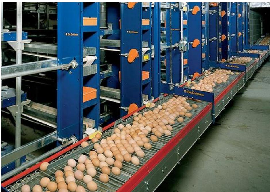
Рис. 2. Система збору яєць обладнання ТБК ДН
