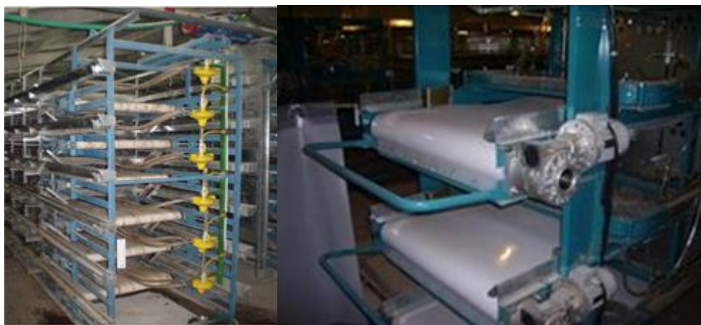
Рис. 2. Конвеєрна п'ятиярусна система видалення посліду.
