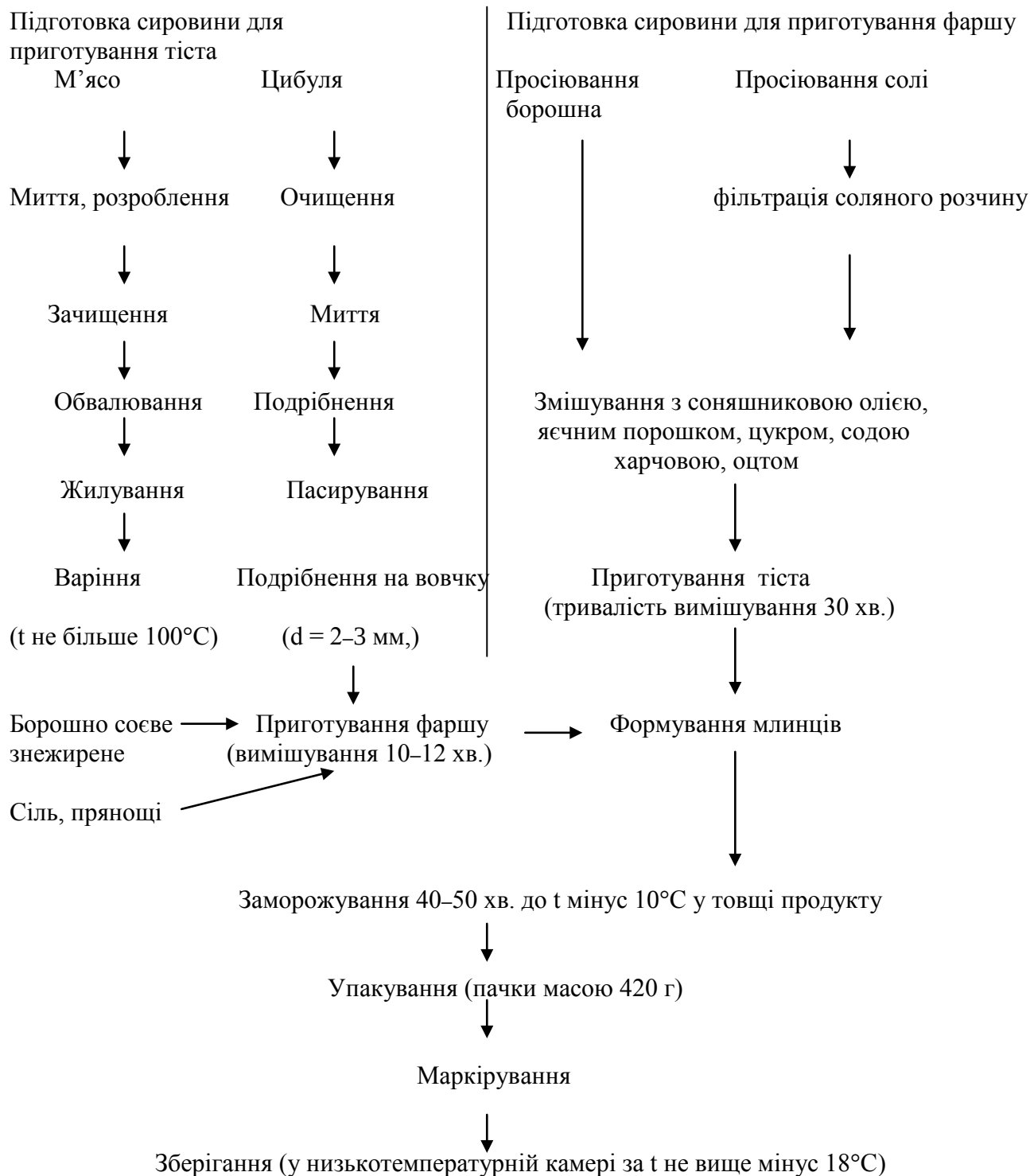
Рис. 1. Технологічна схема виробництва млинців
