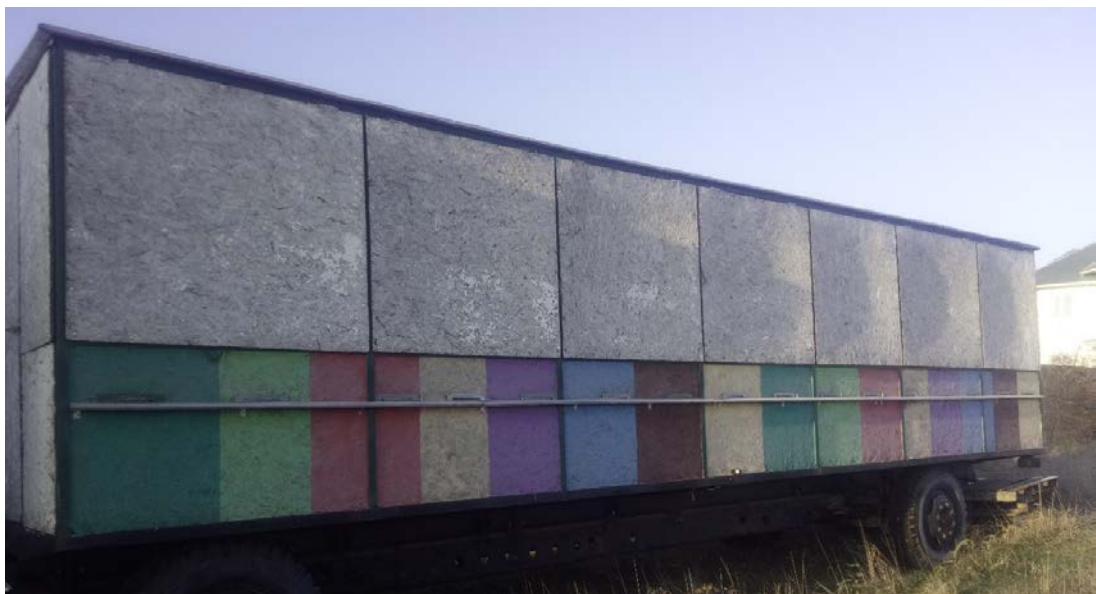
Рис. 2. Причипна платформа для розміщення бджолиних сімей.
