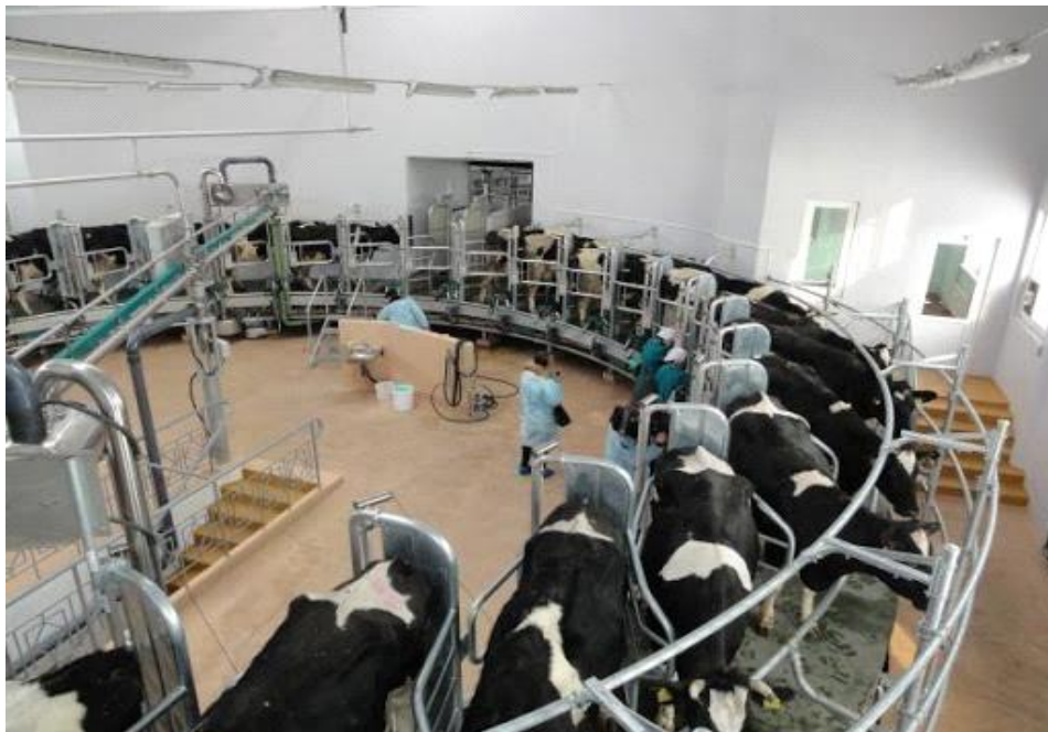
Рис. 3.8 Доїльна установка типу «Карусель» зі станками типу «Ялинка»
